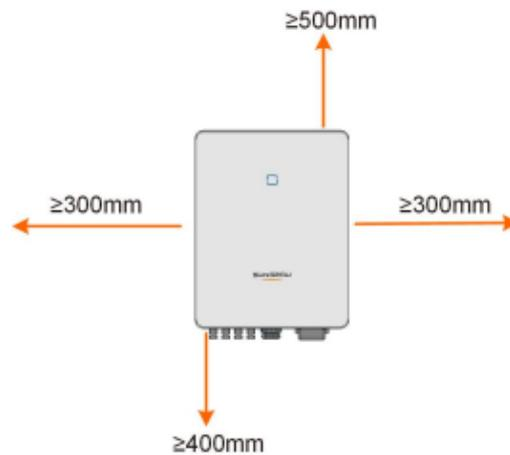
Bei mehreren Wechselrichtern muss ein bestimmter Abstand zwischen den Geräten eingehalten werden.
