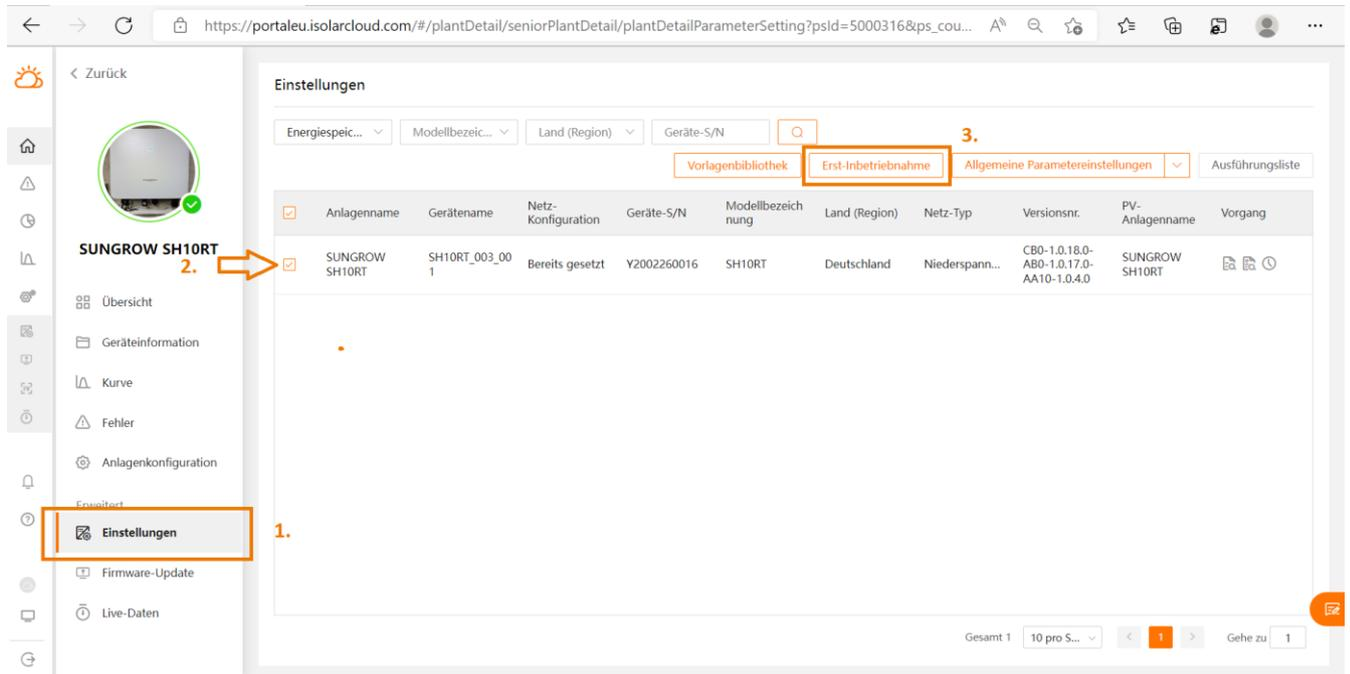
Wählen Sie nun das Land in dem der Wechselrichter installiert ist und stellen Sie ggf. weitere netzspezifische Parameter ein. Anschließend werden die Parameter mit **Einstellungen anwenden** an den Wechselrichter gesendet und gesetzt.
