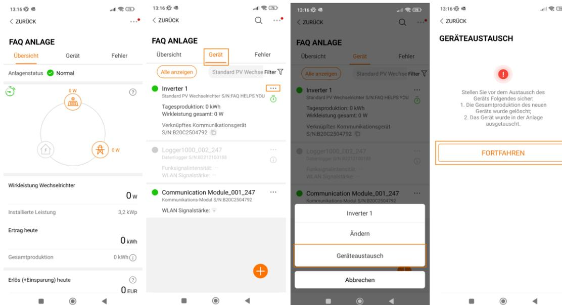
Wählen Sie nun **+** um den getauschten Wechselrichter zur Anlage hinzuzufügen. Sie können nun entweder manuell die Seriennummer eingeben oder den QR-Code am Wechselrichter einscannen. Nachdem die neue Seriennummer erkannt wurde, wählen Sie **AUSTAUSCH BEGINNEN**.
