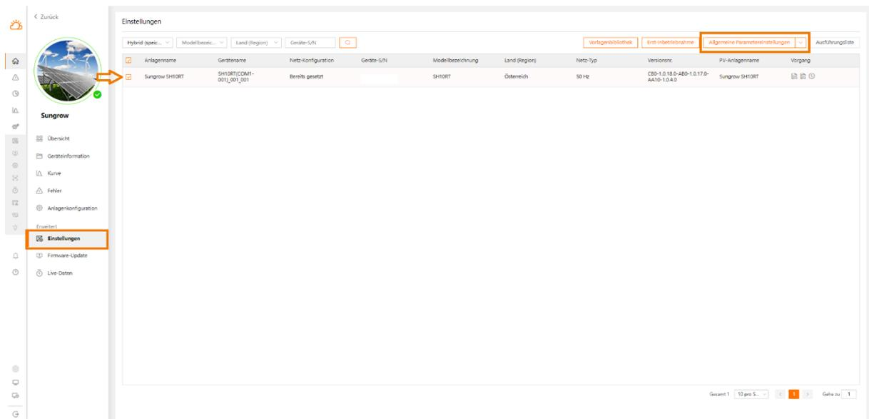
Navigieren Sie in den **Allgemeinen Parametereinstellungen** zu **Leistungs-Reglungsmodus** und aktivieren Sie den Parameter **Netzunabhängiger Modus**. Setzen Sie nun noch den Wert für **Reservierter Batterie SOC für Backup**. Wählen Sie Einstellungen anwenden. Bitte beachten Sie, dass der eingestellte Batterie SOC nicht für den täglichen Gebrauch zur Verfügung steht, da er für eventuelle Stromausfälle reserviert ist.
