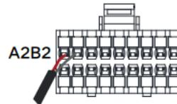
Sollte es nicht möglich sein, die Verbindung vor Ort zu überprüfen, kann man ein Vertauschen der Adern software-seitig korrigieren. Setzen Sie hierfür den Parameter **Energiezählerverbindung umgekehrte Fehlerbereinigung**.
